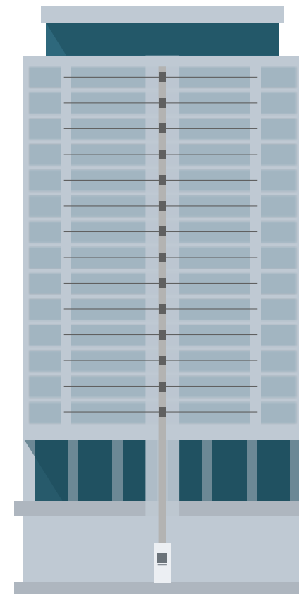
Sistema com Barramento Blindado
